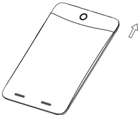
安装时请按下图箭头所示向下扣合 SIM 卡盖：
