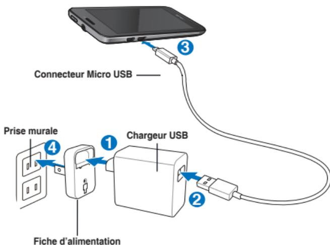
**ATTENTION :** vérifiez soigneusement les connexions et assurez-vous que la fiche d'alimentation soit correctement branchée au chargeur pour éviter la surchauffe et d'endommager les câbles, le chargeur ou l'appareil.
