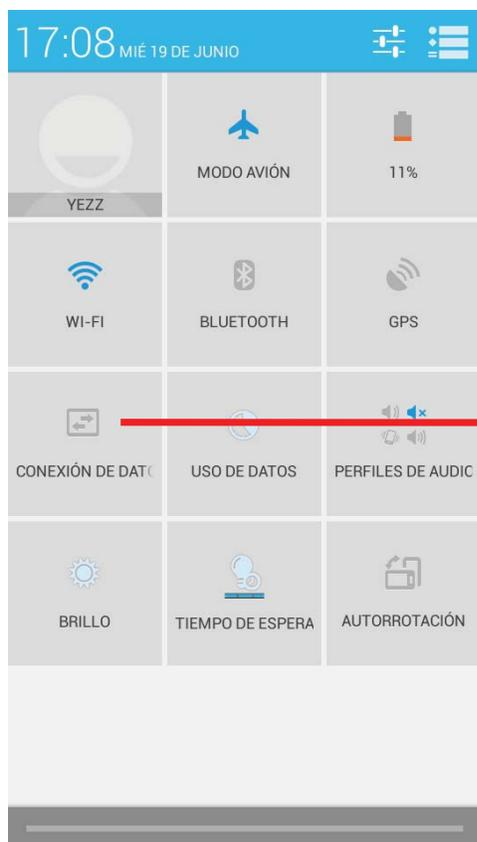
Toque el ícono en la barra de notificaciones para activar o desactivar la conexión de datos
