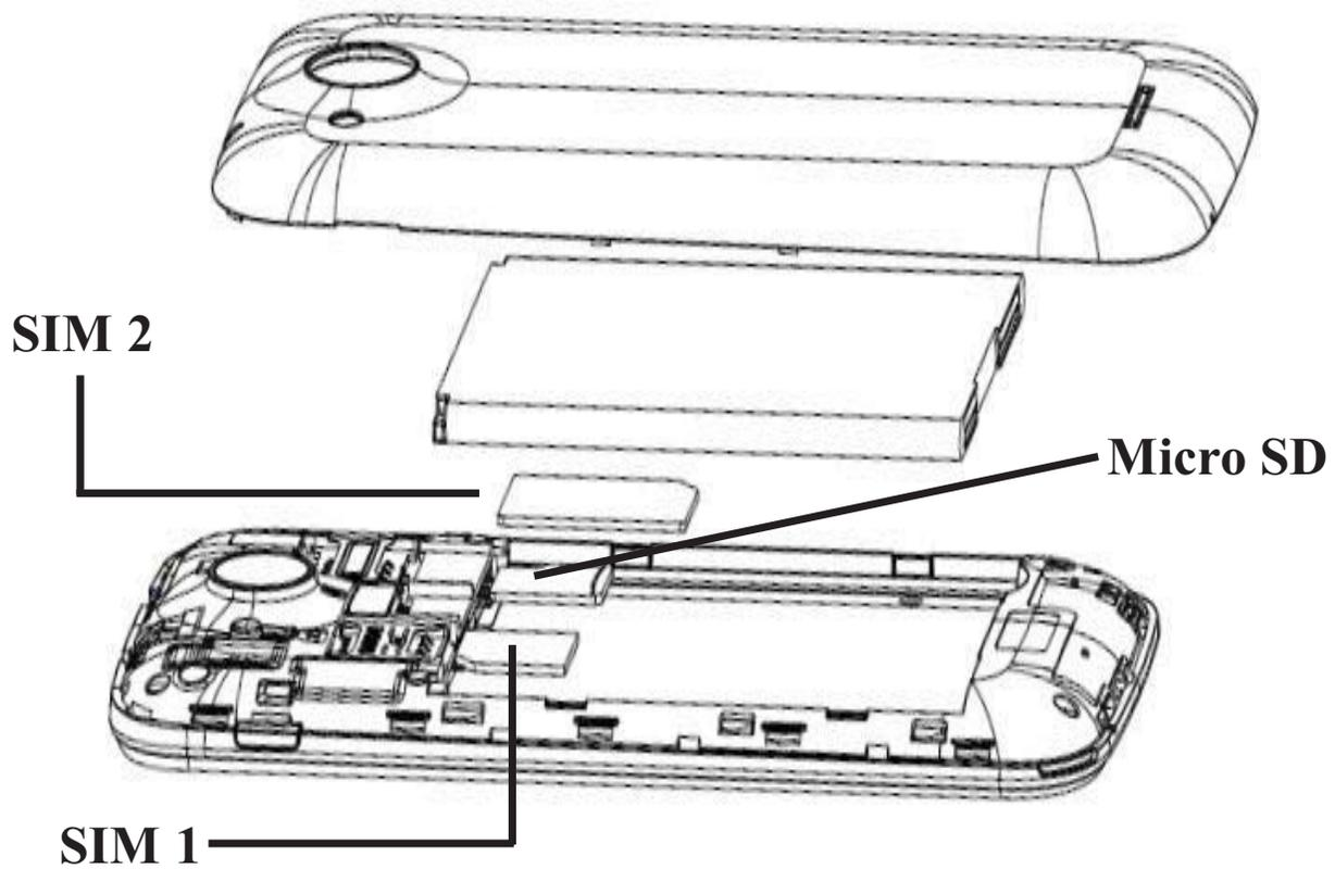
3. Finalmente inserte la batería y coloque la cubierta trasera.
