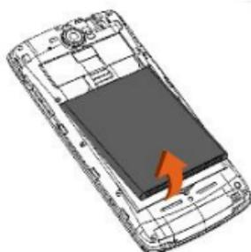
Рис.2. Съем задней панели и аккумулятора
