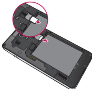
3. Inserte la batería en su sitio alineando los contactos dorados del teléfono y la batería ❶ y presiónela hacia abajo hasta que encaje en su sitio ❷.
