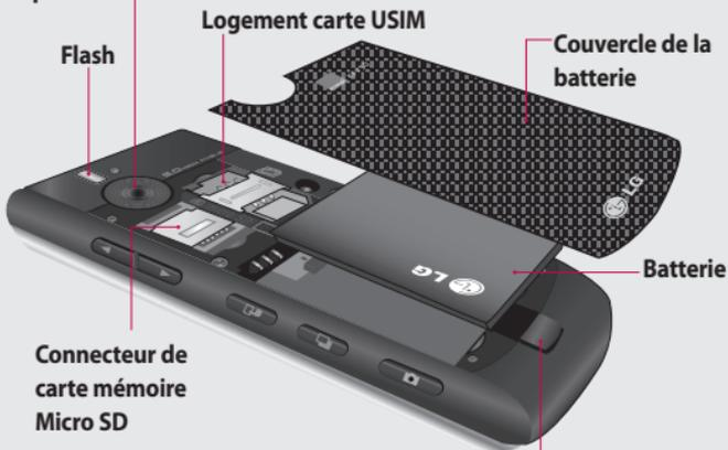
**Bouton d'ouverture/de fermeture de la batterie**
