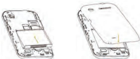
**警告：** 拆卸电池之前一定要将手机关机并移去外部电源。绝对禁止在开机的情况下直接取出电池，否则可能损坏 SIM 卡和手机。
