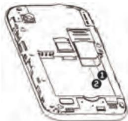
SIM 卡卡槽 1 支持：联通 3G（联通 WCDMA）和 GSM 2G 卡（移动 GSM 和联通 GSM）。
