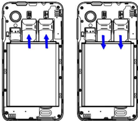
当您需要取出 **SIM** 卡时，请先关机，移去其他外部电源和电池，再取出 **SIM** 卡。
