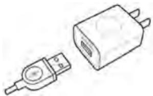
**注意:** 避免金属物碰触充电引脚造成短路,以防电脑或手机 USB 口烧坏,请先连接手机端,后连接电脑端。
