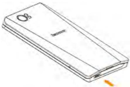
将 USB 数据线的一端和手机连接后，另一端插入旅行充电插头，然后将旅行充电插头接入电源插座。或者直接 USB 数据线插入电脑的 USB 口进行充电。
