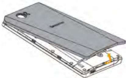
(2) 将 SIM 卡金属触点朝下插入卡槽。
