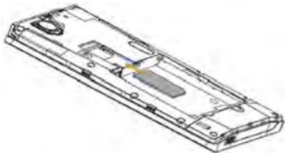
(3) 将电池的铜片部位对准电池槽的金属接触点，轻轻将电池推入。
